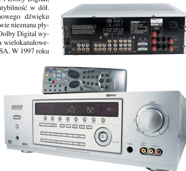
Amplituner DPL 2000 Screnium firmy Thomson. Dekodery Dolby Digital i DTS Moc 5x60W cena 1900 PLN
