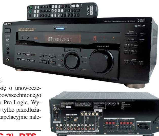
Amplituner STR-DE545 firmy SONY zawiera dekodery DOLBY DIGITAL i DTS a także promowany przez SONY Digital Cinema Sound. Moc wyjściowa 5x80W cena 1700 PLN
