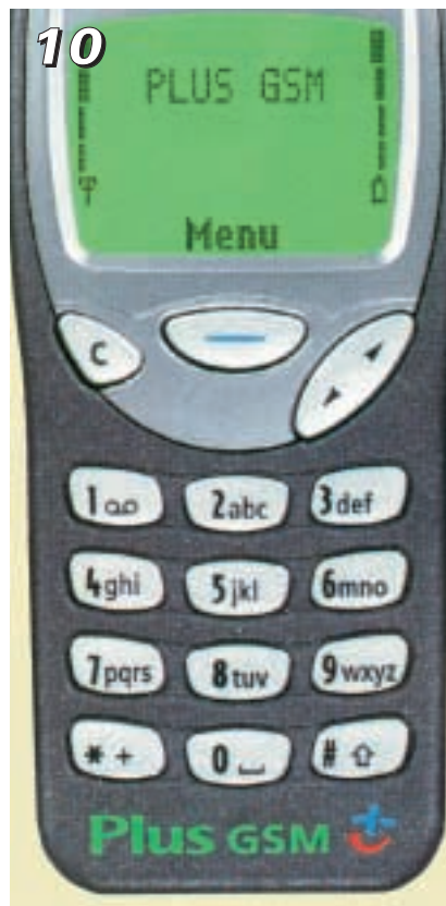
Aparat GSM z wbudowanym SIM-LOCK-iem. Napis na dole obudowy określa w jakiej sieci może pracować.
