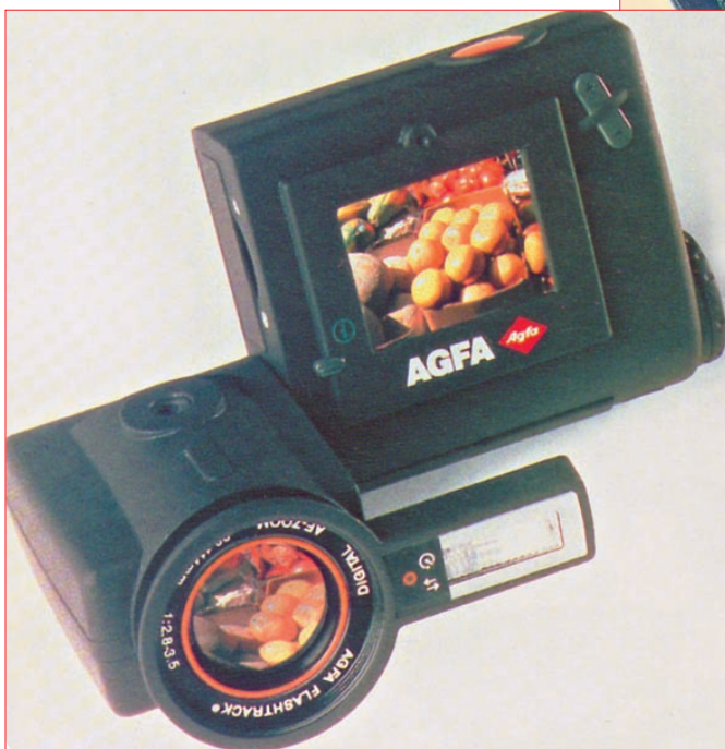
Rys. 1. Cyfrowy amatorski aparat fotograficzny Agfa ePhoto 1280 umożliwia wykonywanie zdjęć do 1,2 miliona pikseli. Fotografie są zapisywane na karcie SmartMedia 4 lub 8MB. Kosztuje 1470 CHF (około 3200zł).
