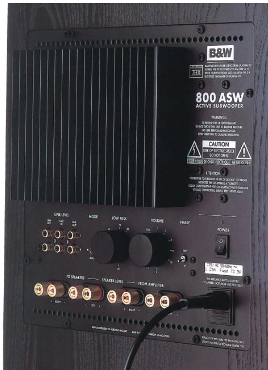
Pełny zakres regulacji aktywnego subwoofera B&W 800ASW – możliwość sterowania sygnałem niskonapięciowy (wejścia RCA „line”) i wyjścia na satelity z sygnałem przefiltrowanym (aktywnie, 18dB/okt.), wejścia z sygnałem już wzmacnionym („speaker level”) i wyjścia na satelity z sygnałem przefiltrowanym biernie, 6db/okt. Górna częstotliwość graniczna pracy subwoofera regulowana w zakresie 40-135Hz, dolna częstotliwość graniczna (-6db) – 15Hz (!). Przelączana faza, regulowane wzmocnienie (moc znamionowa wzmacniacza: 200W). Głośnik 30-cm, w obudowie bass-reflex.
