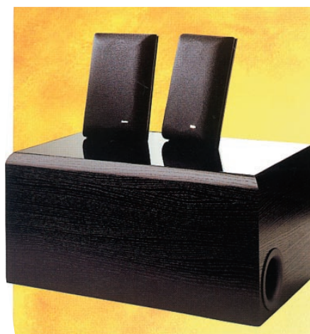
Klasyczny, trzyczęściowy system „sub-sat” firmy Dantax, z miniaturowymi satelitami i subwooferem z obudową pasmowo-przepustową. Głośnik średniotonowy w satelitach ma średnicę 10cm, głośniki niskotonowe w subwooferze (konfiguracja Push-Pull) średnicę 20cm. Częstotliwość podziału wynosi 200Hz.
