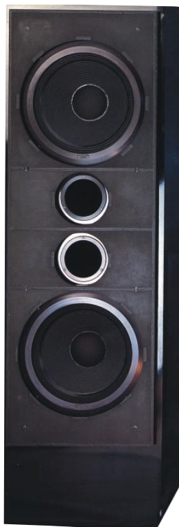
Gigantyczny subwoofer Wilson Audio X-S (500kg sztuka), przeznaczony do współpracy z niewiele mniejszymi X-1 „Grand Slamm”. Subwoofer ten, zbudowany w oparciu o dwa 18-calowe głośniki w komorach bass-reflex, przetwarza tylko najniższe częstotliwości – od 20 do 50Hz, mogąc wytwarzać w tym zakresie ponad 120dB.
