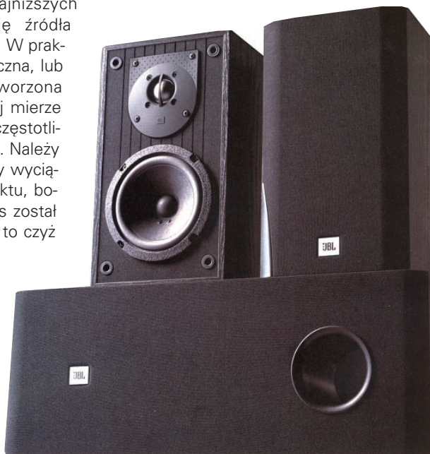
JBL – miniatury subwoofer TLX (obudowa pasmowo-przepustowa, dwa głośniki 13-cm) dedykowany jest małym zespołom głośnikowym TLX 110, które jednak mogą pracować również samodzielnie. Zastosowanie mianatury subwoofera nie przynosi tu wielkich korzyści – dolna częstotliwość graniczna zostaje obniżona z 45Hz do 40Hz. Częstotliwość podziału – 150Hz.
