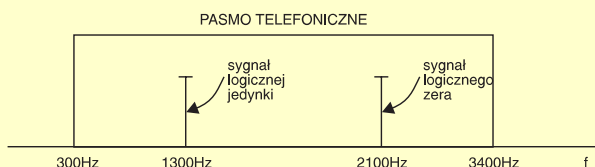
Rys. 6. Prosty sposób przesyłania danych cyfrowych w łączu telefonicznym.
